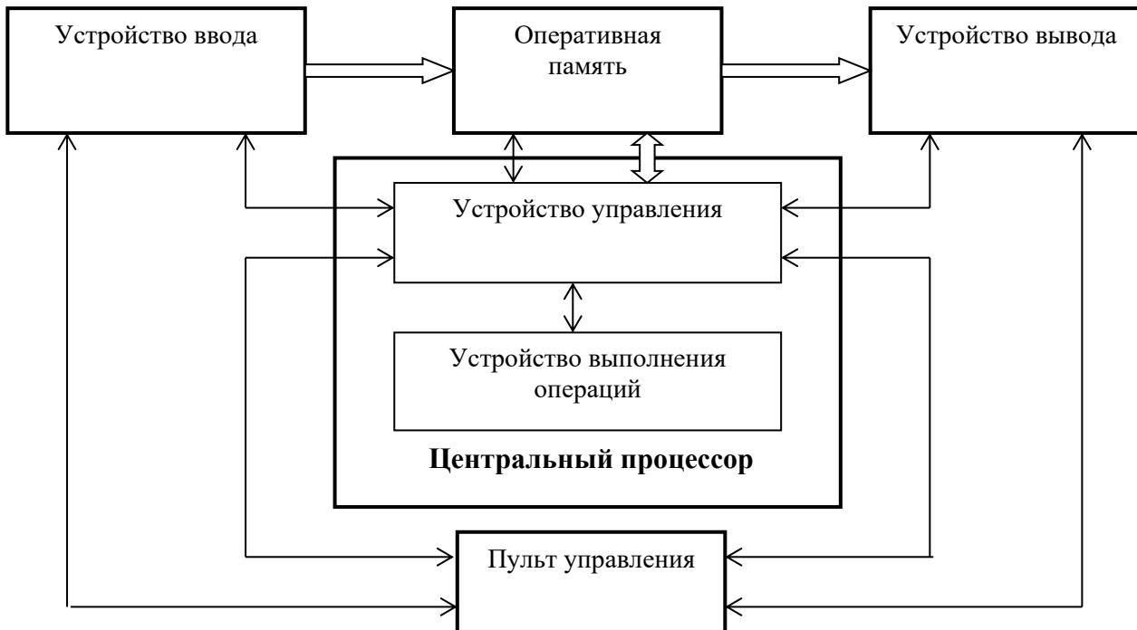
Рисунок II.1.1.С. Классическая архитектура компьютера.
