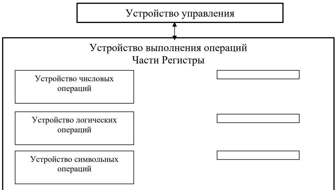
Рисунок II.1.1.В. Структура центрального процессора.
