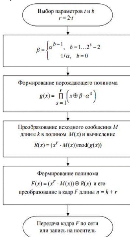
Рис.3. Алгоритм кодирования информационного сообщения с помощью кодов РС
