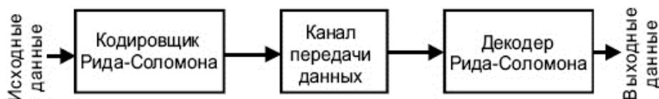
Рис. 2. Схема коррекции ошибок Рида-Соломона
