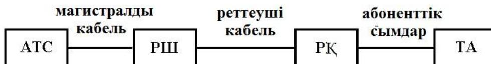
2-сурет. АТС- абонент желісінің негізгі элементтері
